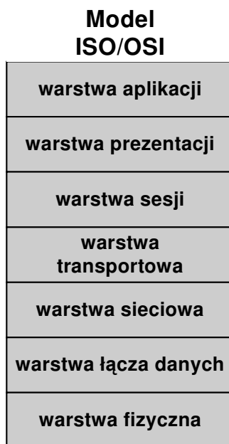
Rysunek 7. Schemat modelu komunikacyjnego ISO/OSI.
