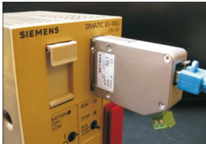
Moduł S5-LAN++ podłączony do sterownika Simatic S5-100U
