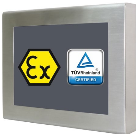
Komputer do strefy Ex serii AEX-P526, widok od frontu, ekran 15"
