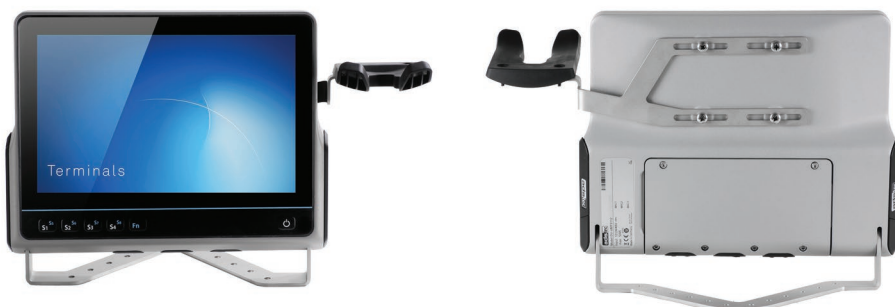
Terminal VMT9112 z uchwytem na skaner i ze specjalnym adapterem montażowym
