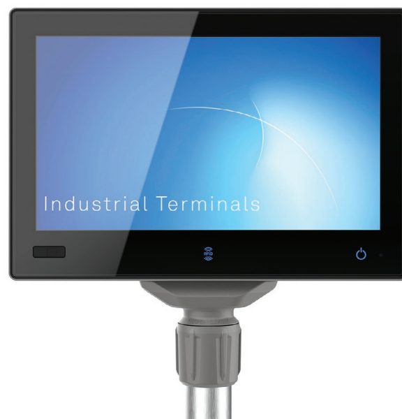
Komputer MES9000 zamontowany na rurze 48 mm. Od frontu widoczny czytnik RFID
